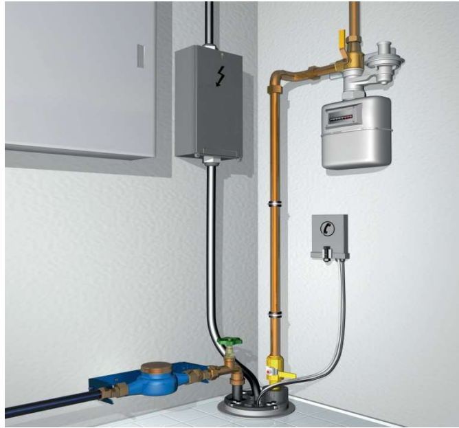
© Fachverband Hauseinführungen für Rohre und Kabel e.V. Mehrspartenhauseinführung für Gebäude ohne Keller (Innenansicht)
